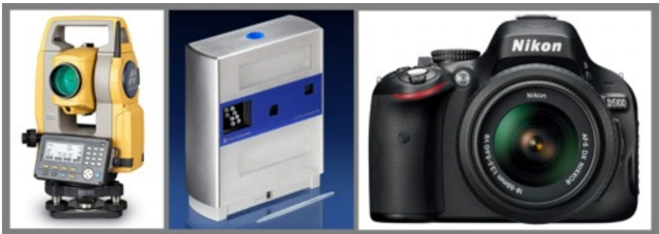
Figura 1 – Apparecchi impiegati per eseguire il rilevamento dell'affresco: Stazione totale Topcon DS, NextEngine 3D Laser Scanner, Fotocamera Nikon D5100.
